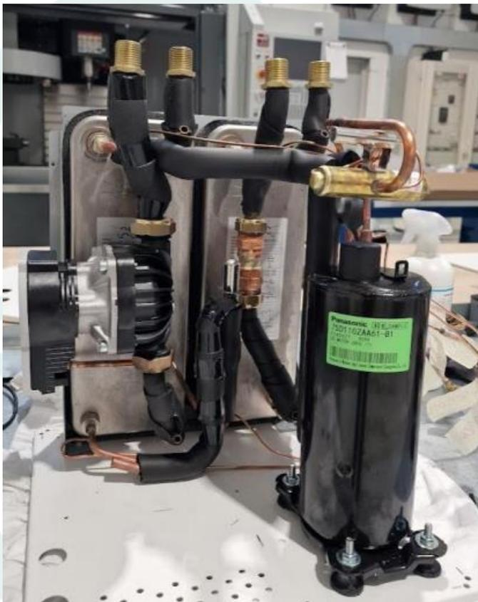
**WTW in R290** per la generazione dell'acqua calda sanitaria (da abbinare al accumulo sanitario).
