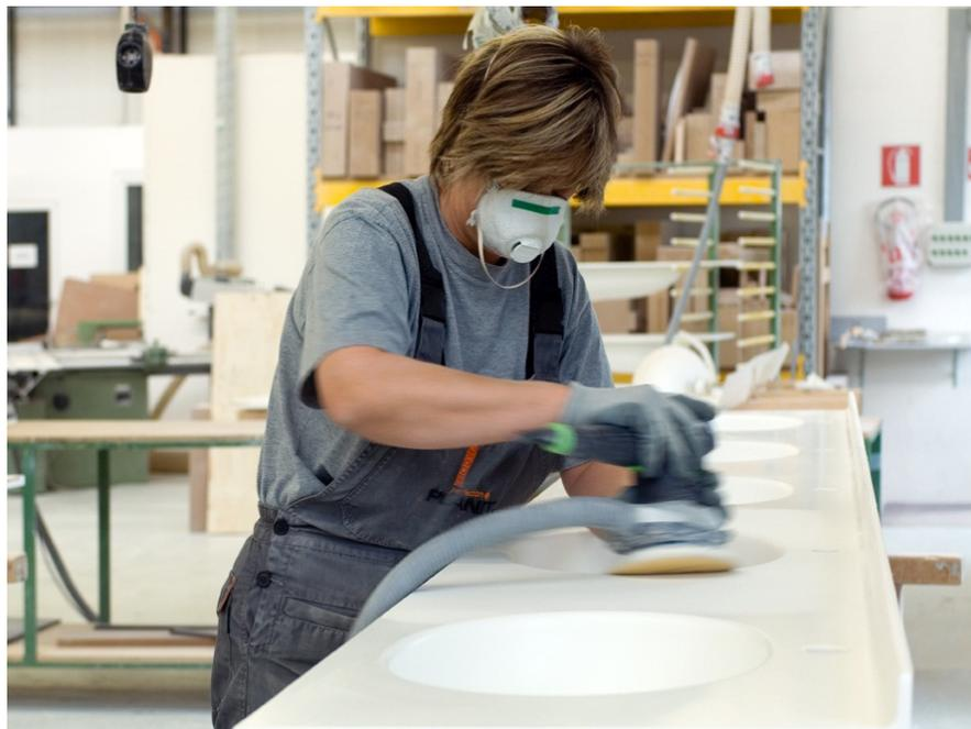
Le nostre maestranze sono specializzate nell'**assemblaggio e incollaggio** dei componenti con un adesivo speciale. Questa tecnica permette di ottenere pezzi esclusivi senza giunzioni visibili. Dopo la levigatura, il prodotto finito viene sottoposto a un **rigoroso controllo di qualità** – ultima ma fondamentale fase del nostro processo produttivo.
