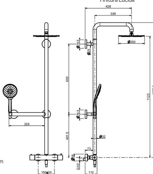
\*Si consiglia l'installazione del miscelatore termostatico ad un'altezza di 110 mm
