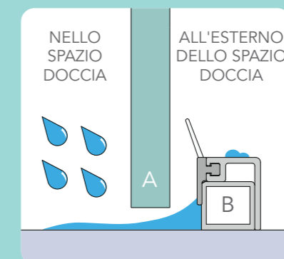
A - Vetro scorrevole B - Canale guida I - Guarnizione aggiuntiva
